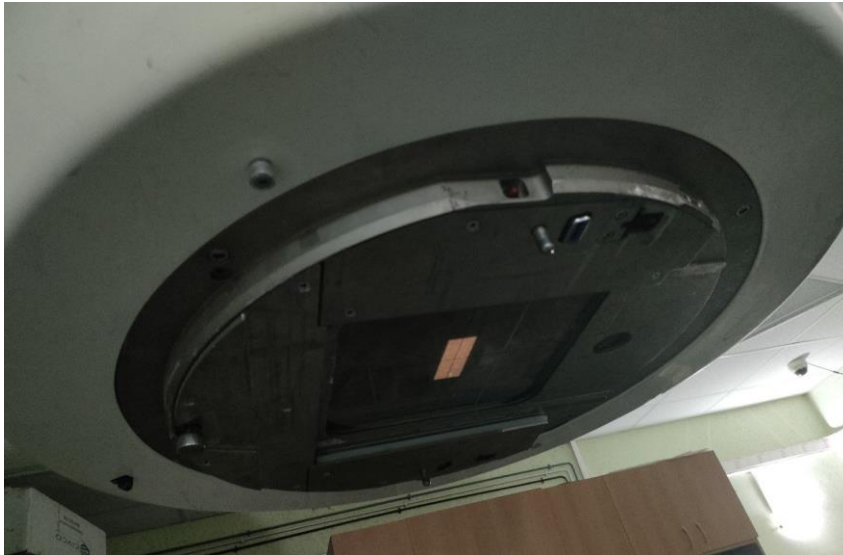
Figure 13 :Collimateur multi-lames (MLC) en radiothérapie
