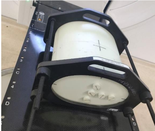
Figure 38:Position des points de mesure (Q1 à Q5) dans le fantôme
