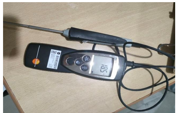
Figure 22 : Dispositif de mesure de la température de l'eau (T) dans le fantôme d'eau.
