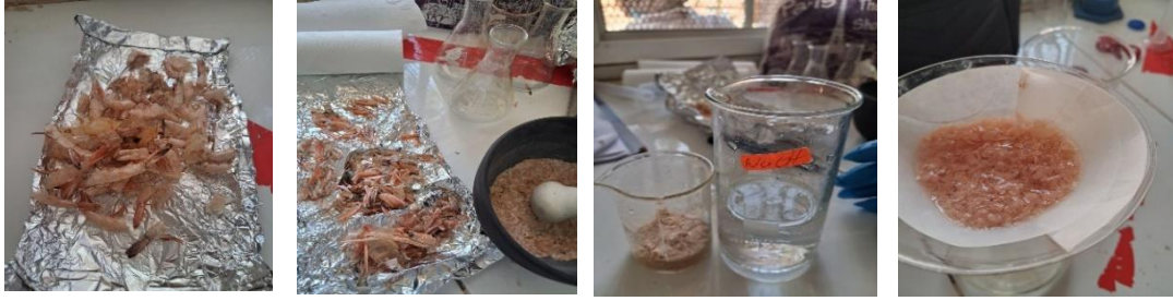
الشكل 7.III. مراحل الاستخلاص الكيميائي للكيوتين من قشور الجمبري.
