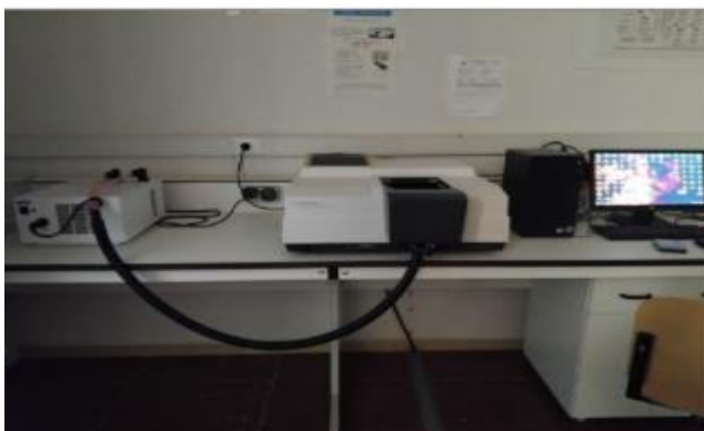
الشكل(1-IV): صورة مطيافية الأشعة المرئية فوق البنفسجية UV-VIS.
