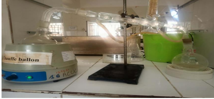
الشكل (2-13): التركيب التجريبي لعملية التقطير
