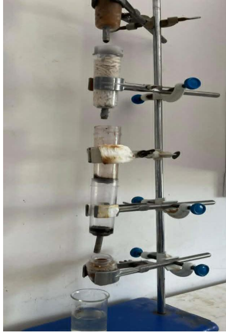
الشكل (2-8): التركيب التجريبي لترشيح العينة
