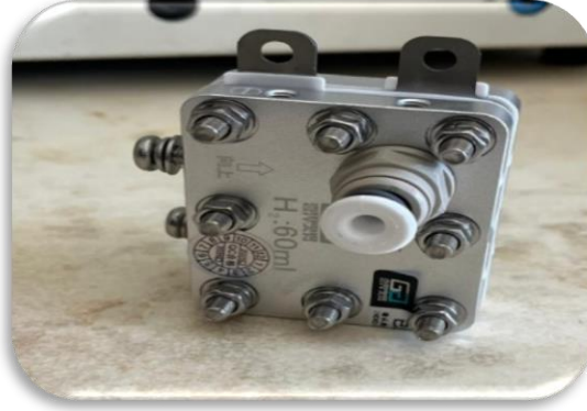
الشكل (9-1): المحلل الكهربائي غشاء تبادل البروتون (PEM)
