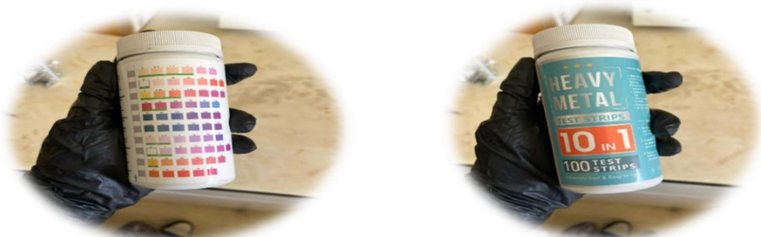
الشكل (2-12): قياس المعادن الثقيلة بواسطة الشرائط اللونية
