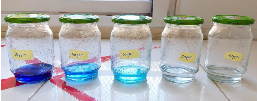
الشكل (III-6): يوضح نتائج اختبار التركيز الابتدائي على عملية الامتزاز
