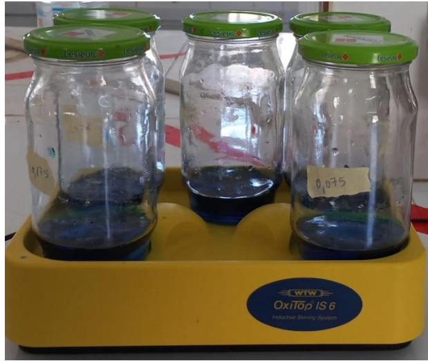
الشكل(II-2): صورة توضح المحاليل على جهاز الرج أثناء عملية الامتزاز
