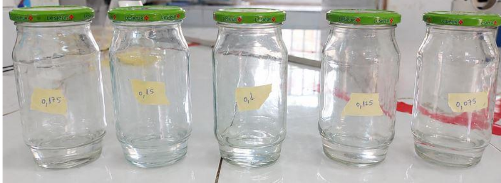
الشكل (III - 2): يوضح نتائج اختبار جرعة الكربون النشط لامتزاز صبغة أزرق الميثيلين
