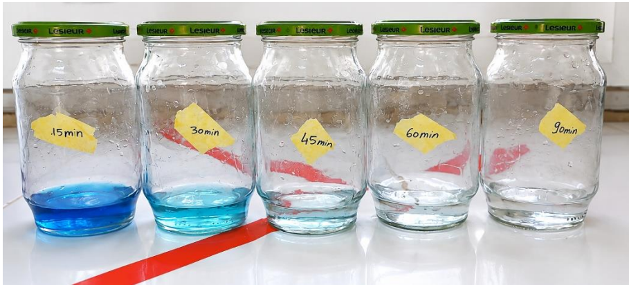
الشكل(III-4): يوضح نتائج اختبار زمن التلامس على امتزاز صبغة أزرق الميثيلين
