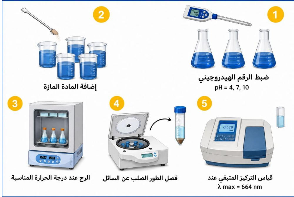
الشكل (8.II): البروتوكول التجريبي المتبع في تجارب الامتزاز (Batch Mode) لصبغة أزرق الميثيلين على الطين المنشط
