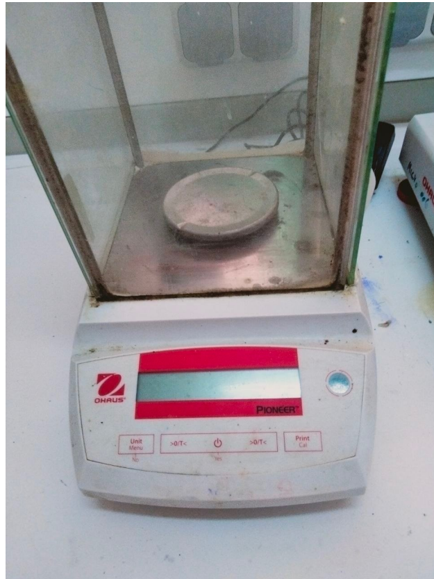
شكل 5.2: الميزان التحليلي (OHAUS Pioneer) المستعمل في وزن المساحيق الأولية والكواشف وعيّنات المسحوق.
