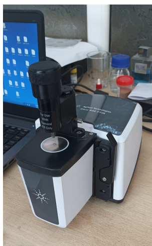
شكل 13.2: مطياف Agilent Cary 630 FTIR المستعمل في التوصيف، بوحدة الانعكاس الكلي المخمد ذات بلورة الألماس (Diamond ATR).
