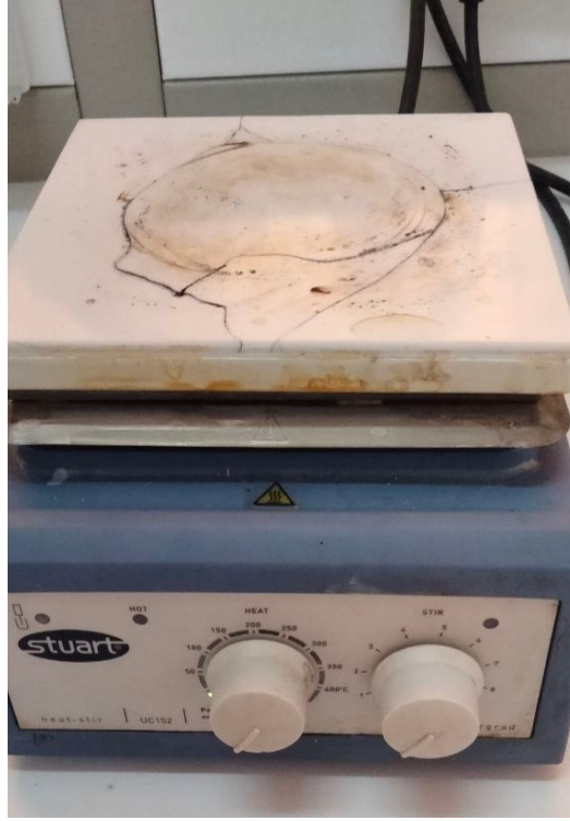
شكل 9.2: لوحة التسخين بمحرك التقليب المغناطيسي (Stuart UC152) المستعملة في إذابة الكواشف بتجانس.
