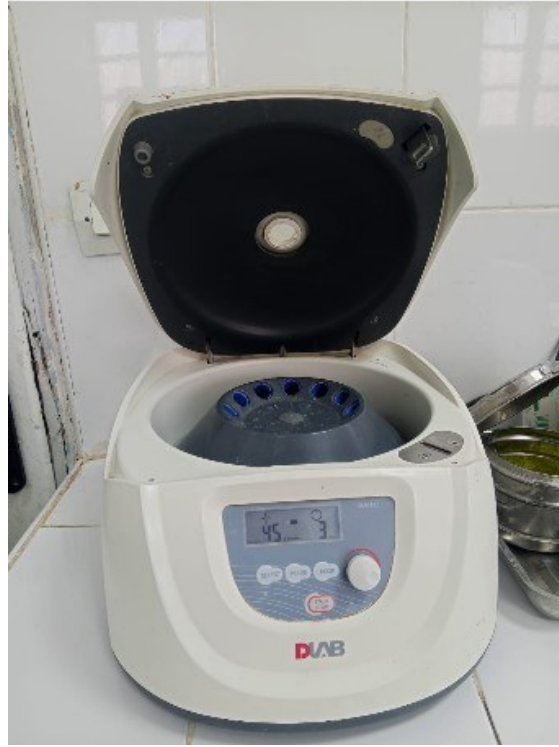
شكل 8.2: جهاز الطرد المركزي (DLAB) المستعمل لفصل الزجاج عن الوسط؛ تُظهر الشاشة 4500 rpm لمدة 3 دقائق.
