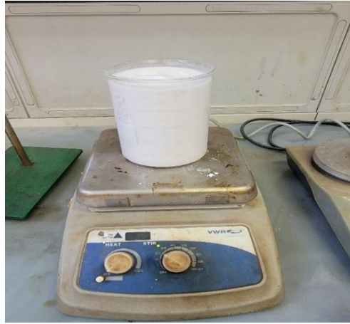
الشكل (II-11): تحضير محلول هيدروكسيد الكالسيوم.
