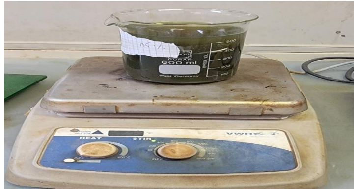
الشكل (II-14): رج العينة بعد إضافة هيدروكسيد البوتاسيوم.
