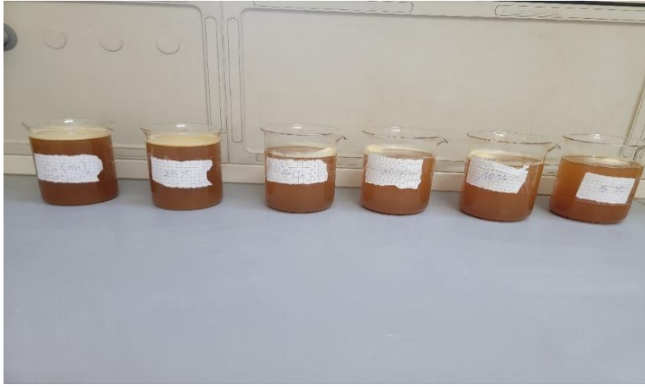
الشكل (II-13): العينة بعد إضافة بيروكسيد الهيدروجين (10%).
