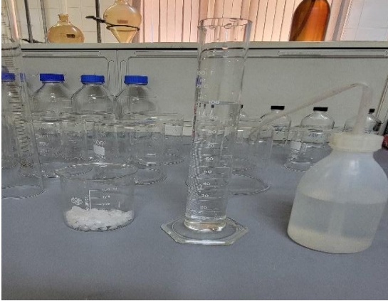
الشكل (II-10): تحضير محلول هيدروكسيد البوتاسيوم.
