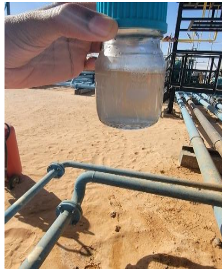
الشكل (II-04): أخذ العينات من مدخل ومخرج وحدة معالجة المياه البترولية.
