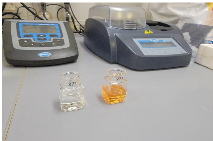
الشكل (II-09): قياس تركيز شوارد الحديد باستخدام جهاز الطيف الضوئي.
