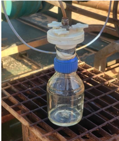
الشكل (II-04): أخذ العينات من مدخل ومخرج وحدة معالجة المياه البترولية.
