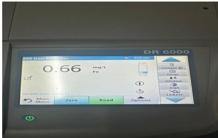
الشكل (18-11): قياس تركيز شوارد الحديد في العينة بجهاز الطيف الضوئي.
