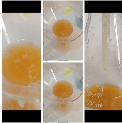
الشكل (11-III) ظاهرة التحرر الفجائي والاحتجاز الغازي لـ CO 2 أثناء الترشيح
