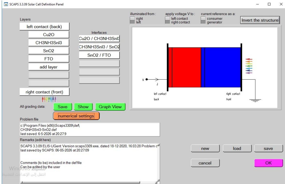
الشكل (III-25): هيكل خلية البيروفسكايت الشمسية باعتبار \text{SnO}_2 المادة الناقلة في برنامج SCAPS-1D
