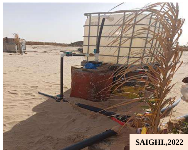
Photo 18. Dispositif local de préparation de la solution phytosanitaire
