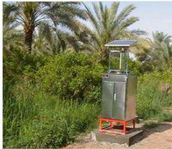
Figure 7: Piège lumineux solaire, utilisé pour la surveillance et le contrôle des espèces d' Oryctes dans les vergers de palmiers dattiers en Irak (Khalaf et al , 2012)
