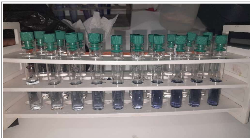
الشكل (8.IV): سلسلة تراكيز حمض الغاليك المستخدمة في رسم منحنى المعايرة
