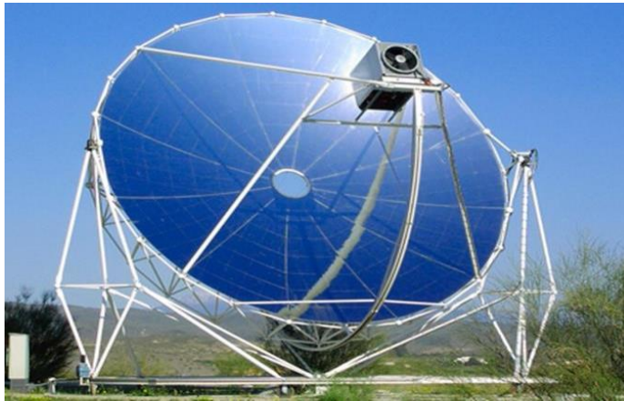
الشكل (2-15): مركز شمسي على شكل قطع مكافئ.
