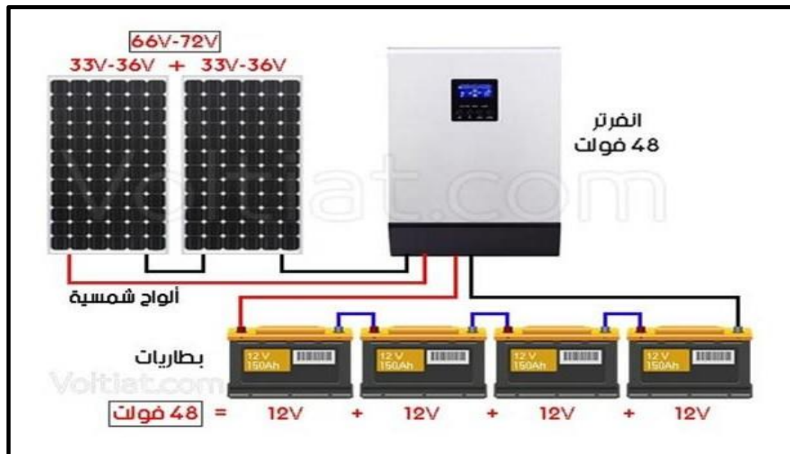
الشكل (3-3): رسم تخطيط لنظام V48
