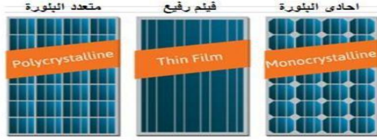
الشكل (II-3) : أنواع الخلايا السيليكون [2].
