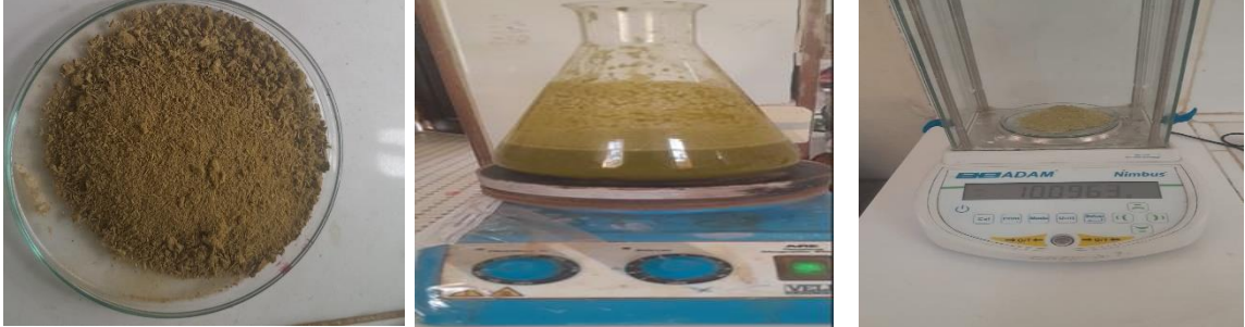
الشكل (III.5) : صورة توضح خطوة نزع البكتين
