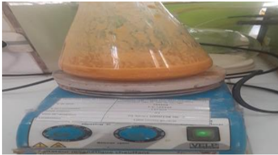
إضافة \text{NaClO}_2 مع التسخين والرج عند 60^\circ\text{C}
