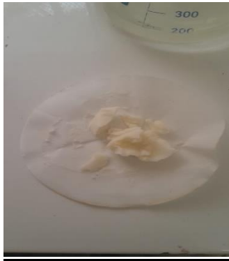
الشكل (10.III): صورة توضح المعالجة الحمضية والسليولوز المستخلص
