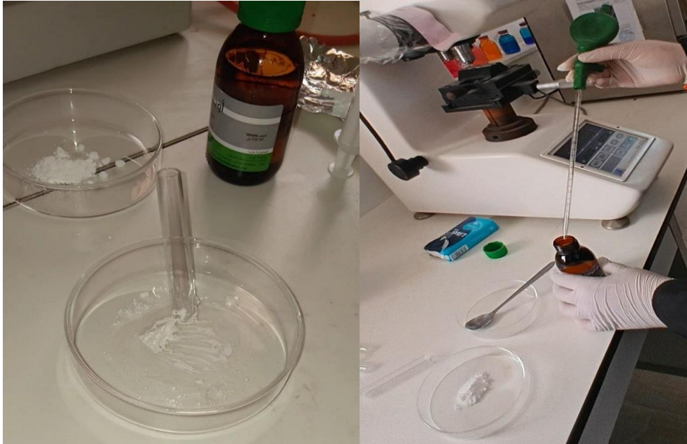
الشكل رقم (3): إضافة كمية من الأوجينول بواسطة حقنة مدرجة وعملية الخلط
