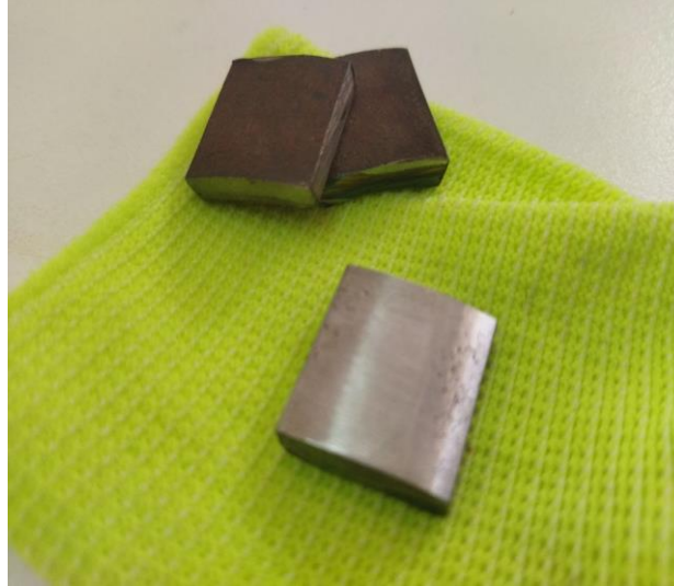
الشكل(III-1): عينات فولاذ كربوني منخفض الكربون مربعة الشكل
