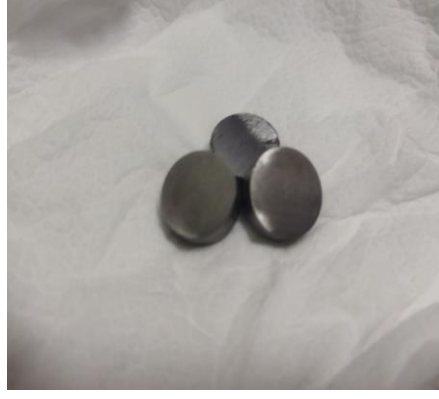
الشكل(III-2): عينات دائرية الشكل من الفولاذ الكربوني منخفض الكربون
