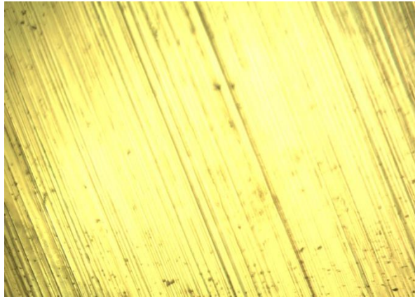
الشكل (2-IV): صورة معاينة مجهرية لعينة بدون مراجعة قبل الغمس في محلول نيتال 2 بالمئة
