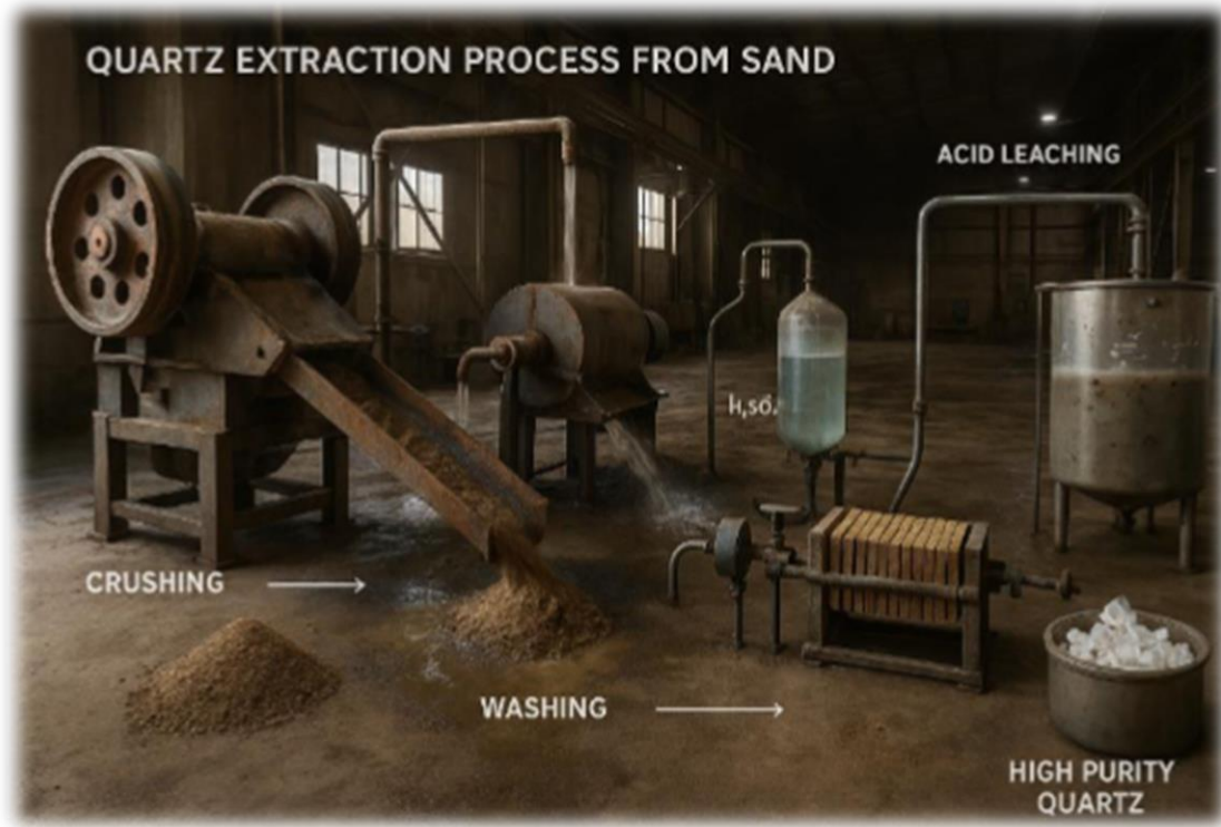
الشكل (3): مراحل استخلاص كوارتز 27
