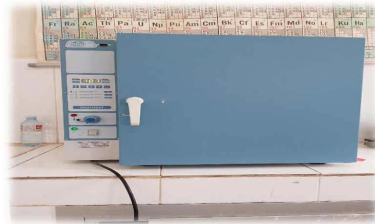
الشكل (9): صورة تجفيف الرمل في الفرن الكهربائي
