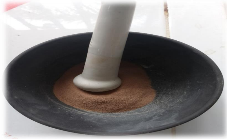
الشكل (10): صورة لطحن الرمل بواسطة هاون
