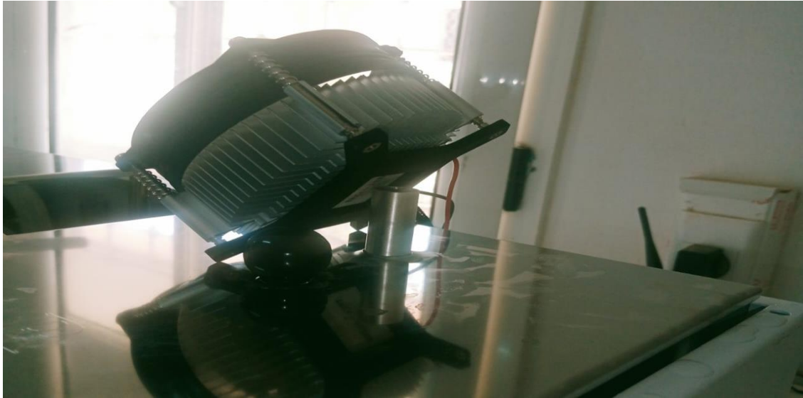
الشكل (III-8): تمثل الصورة تثبيت وحدة التبريد في جهة التكثيف للجهاز
