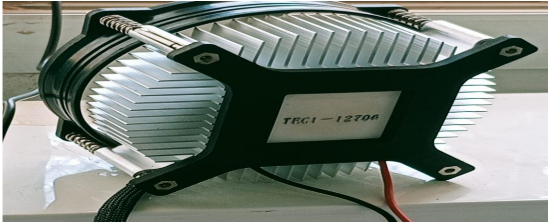
الشكل (III-6): يمثل الشكل وحدة بلتر المستخدمة لتبريد
