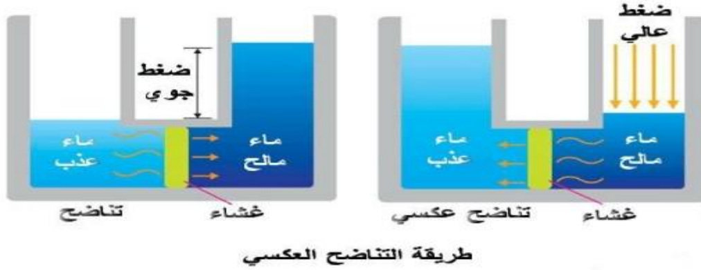
الشكل (II-1): يمثل طريقة التناضح العكسي
