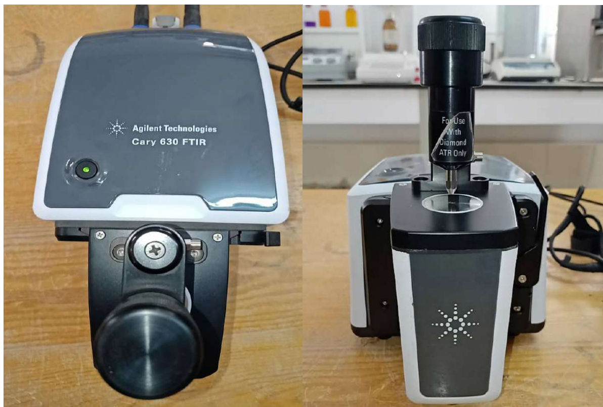
الشكل رقم (III-3): جهاز مطيافية الأشعة تحت الحمراء (FTIR - Cary 630)
