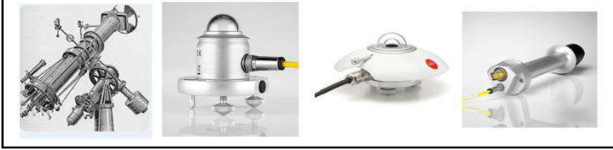
الشكل (10_1) مختلف أجهزة قياس شدة الإشعاع الشمسي [26]
