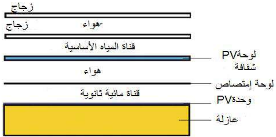
الشكل (3-12) رسم يوضح مختلف التكوينات لمجمع هجين من PV/T [11]
