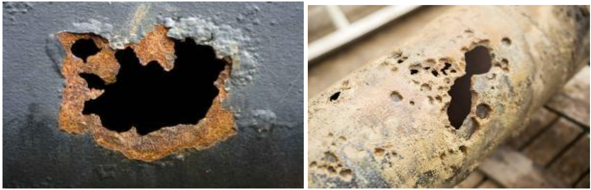
Figure I.6: Corrosion par piqûres
