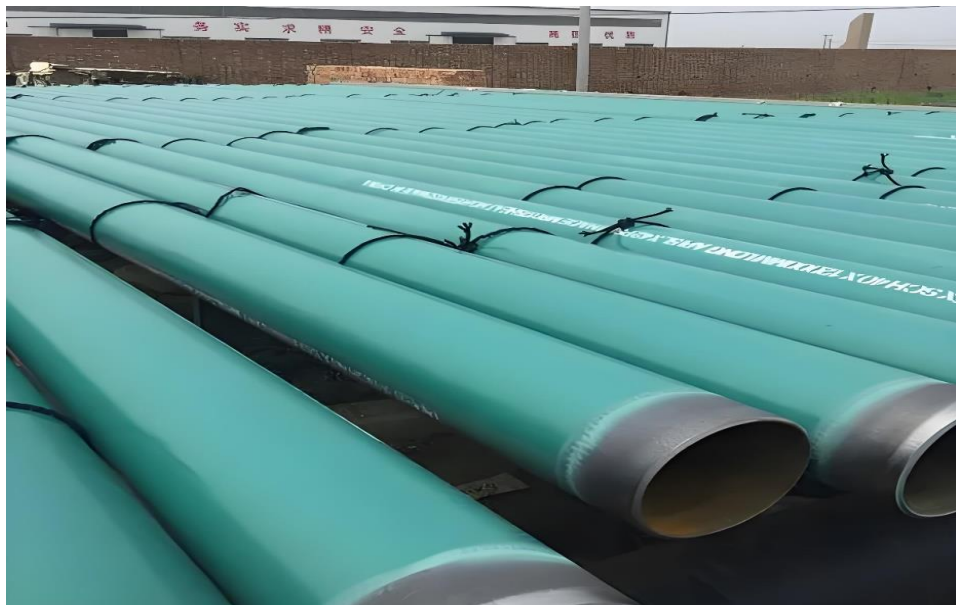
Figure II.5: Protection par revêtement métallique et organique
