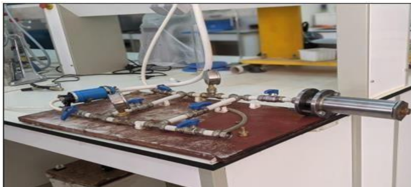
Figure III.22: Schéma du système de mesure de la perméabilité du proppant [22]
