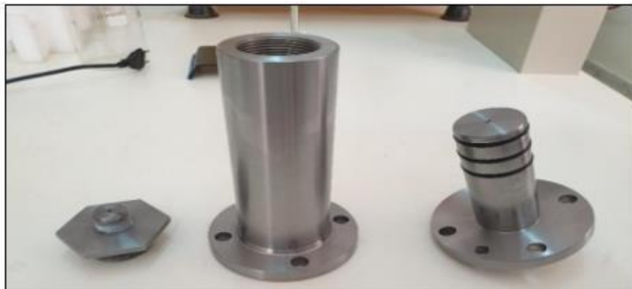
Figure III.21 : Composants de pistons fabriqués.
