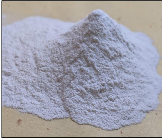
Figure III.16 : Échantillon de guar utilisé dans les tests [22]
