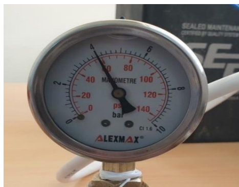
Figure III.24 : Manomètre utilisé (0 à 10 bars) [22]
