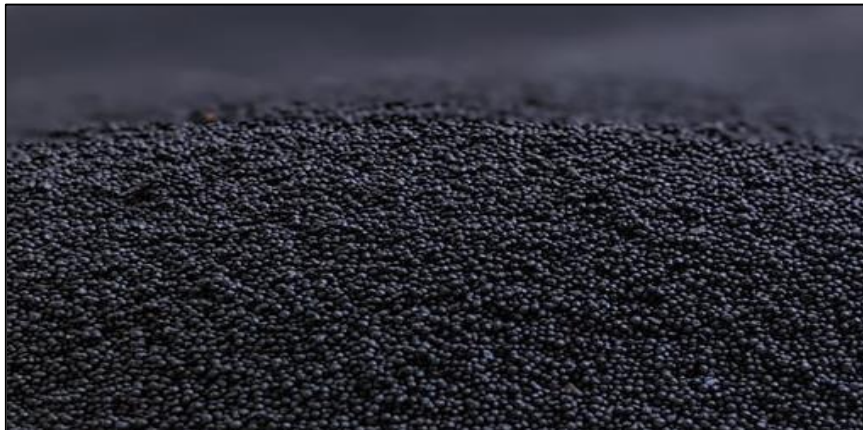
Figure III.17 : Proppant de bauxite de taille 20/40 utilisé dans les expériences [21]
