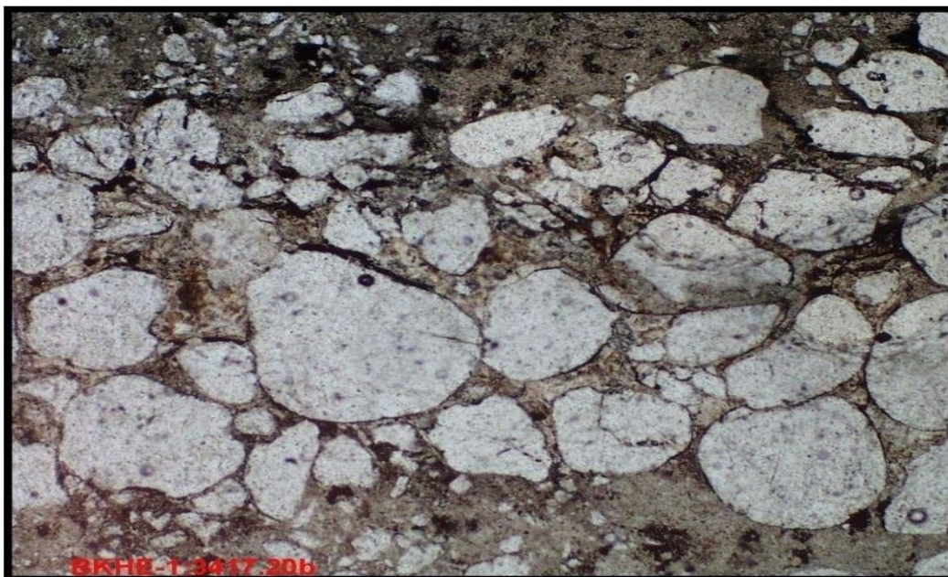
Figure 07: microphotographie de grès de l'échantillon de carotte (BKHE-1 : 3417,20m), a : image de microscope par polarisant (LP), b : par lumière naturel (LN)
