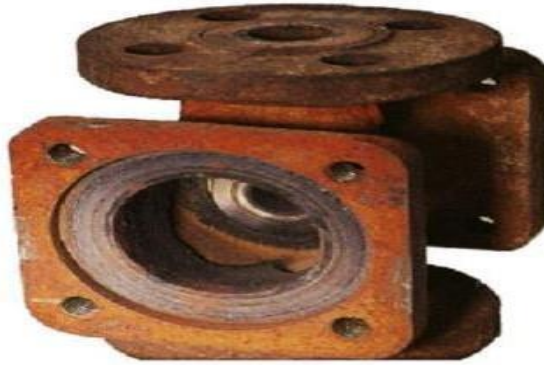
Figure 10 : Corrosion générale (rouille) d'une pièce en acier [10].
