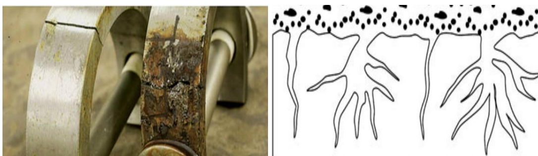
الشكل (1-5) صورة لتآكل بالإجهاد "ا" و"ب" على التوالي
