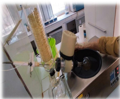
الشكل (14-1): صورة لطريقة إزالة المذيب باستخدام المبخر الدوار
