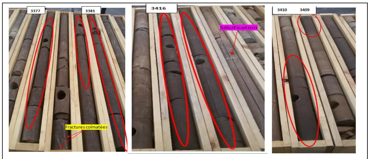
Figure III.9: Photos carotte n°2, n°3 et n°4 du puits HTF25.
