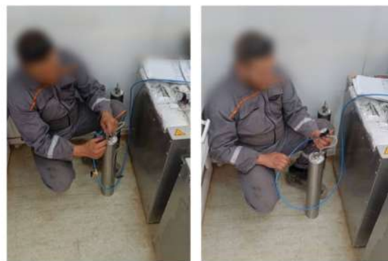
FIG. 2.13 – La purge de canister avec de l'hélium pour le nettoyer.
