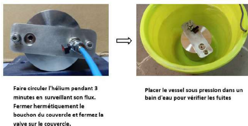
FIG. 2.29 – Procédure de test d'étanchéité par hélium et immersion hydraulique.
