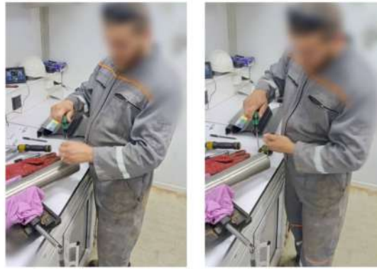
FIG. 2.20 – La mise en place de vis antidéflagrante après la hausse de la température.
