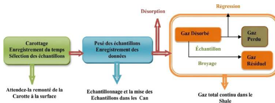
FIG. 2.1 – Schémas de mesure de la désorption du gaz de schiste (document interne2018)
