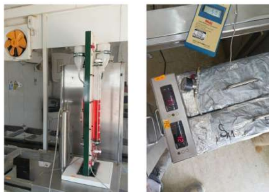
FIG. 2.22 – Réglage de la température de bain électrique par rapport à la température de la circulation de la boue de forage et le début de lecture.
