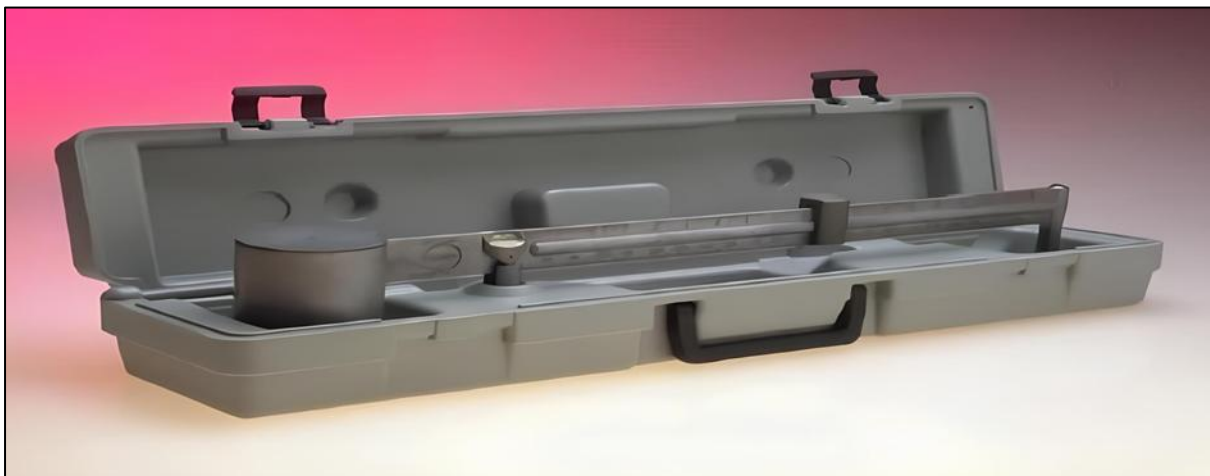
Figure 9: Appareil de mesure de la densité de la boue de forage (mud balance).
