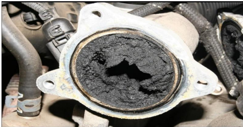
Figure IV.14: Accumulation de carbone et dépôts dans la vanne EGR.
