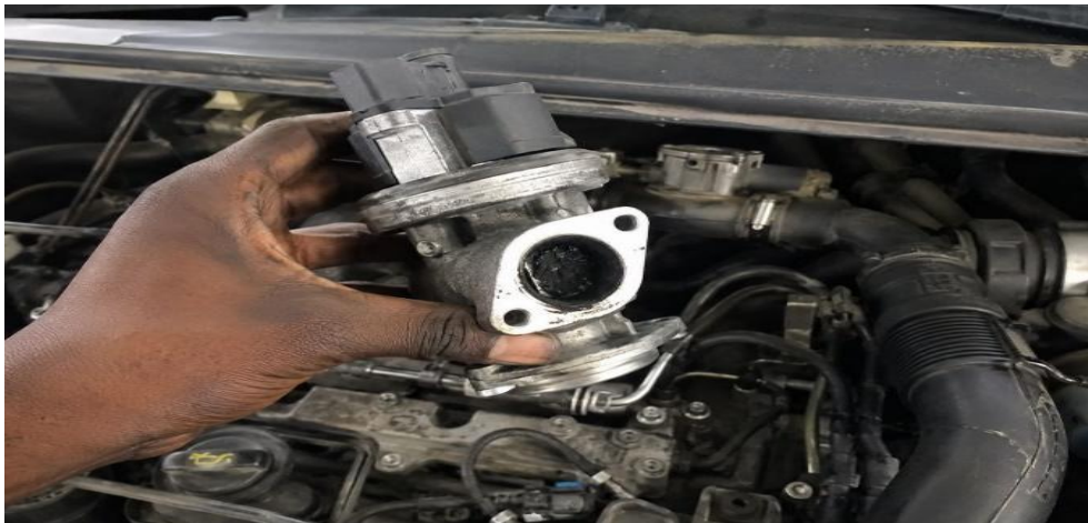
Figure IV.16: Nettoyer la vanne pour EGR
