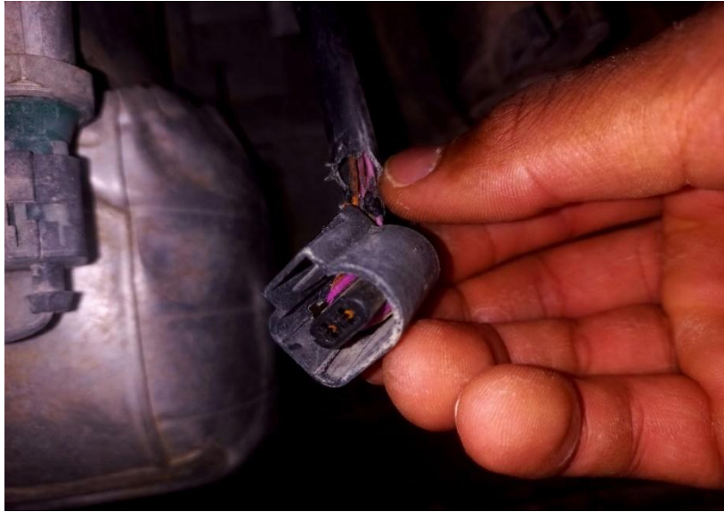
Figure IV.9: Image montrant la rupture du fil reliant le capteur de température et l'unité de commande.
