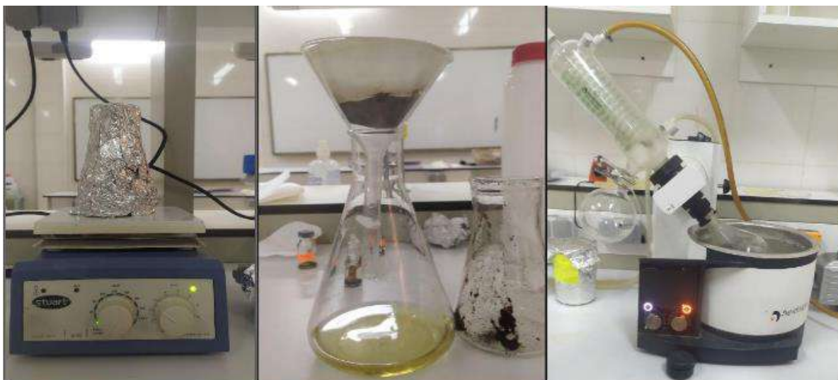
Photo 1 : Macération, Filtration et évaporation avec rotavapeur rotatif
