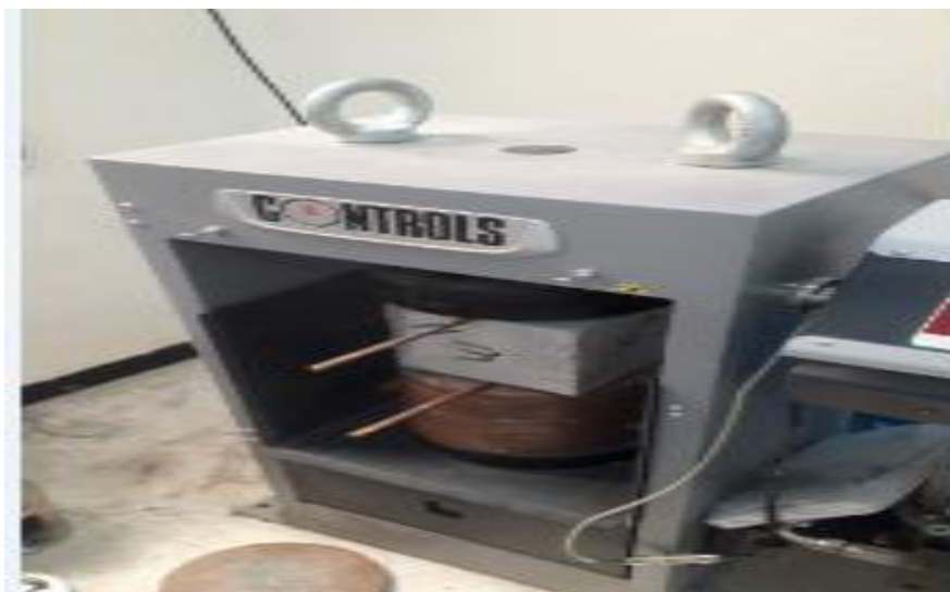
Figure IV.33 : Fendage des éprouvettes pour mesurer la profondeur de pénétration d'eau.
