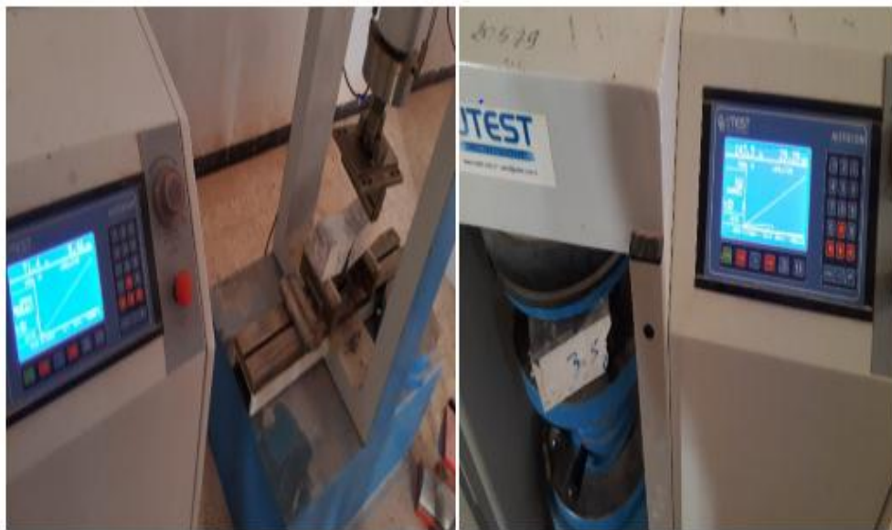
Figure IV.06: Appareil d'essais, de la compression, flexion et de traction par fendage
