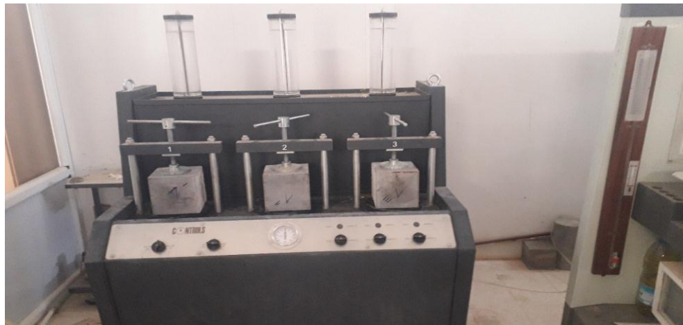
Figure IV. 30 : Déroulement de l'essai par un perméabilimètre Controls 55-C0246/3.
