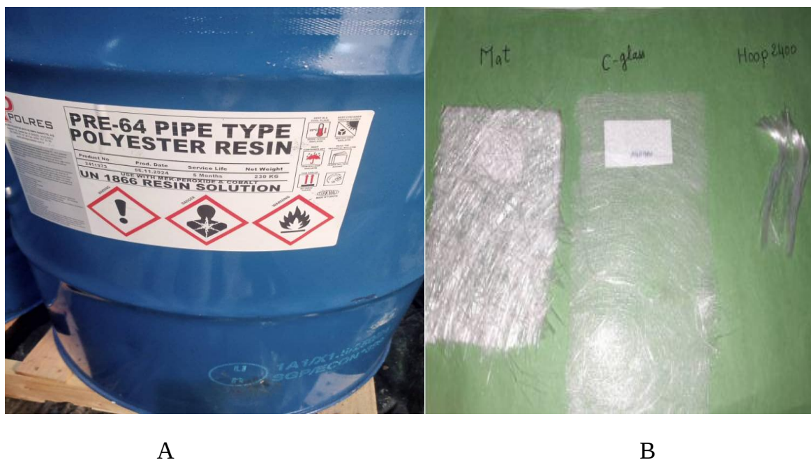
Figure IV.65 : Type de la résine et fibres utilisés dans la fabrication des regards.
