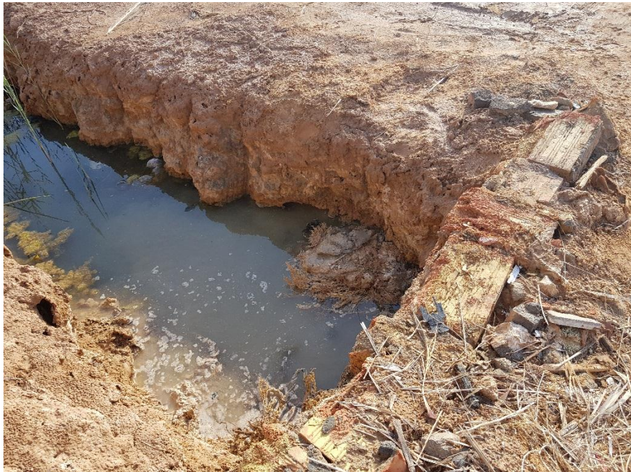
Figure IV.05: Conservation des éprouvettes dans un milieu agressif (tranchée agricole).
