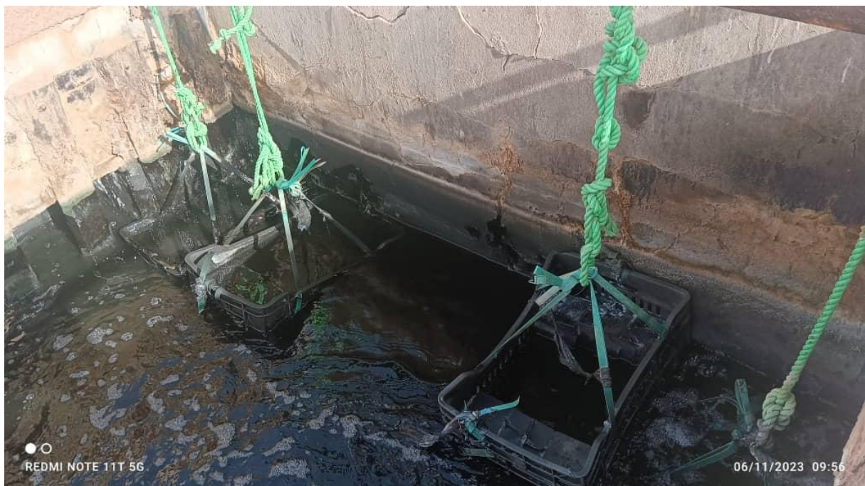
Figure V.16 : Conservation des éprouvettes dans les eaux usées .
