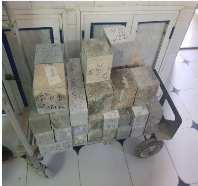
Figure IV.04: Prélèvement des éprouvettes de béton.
