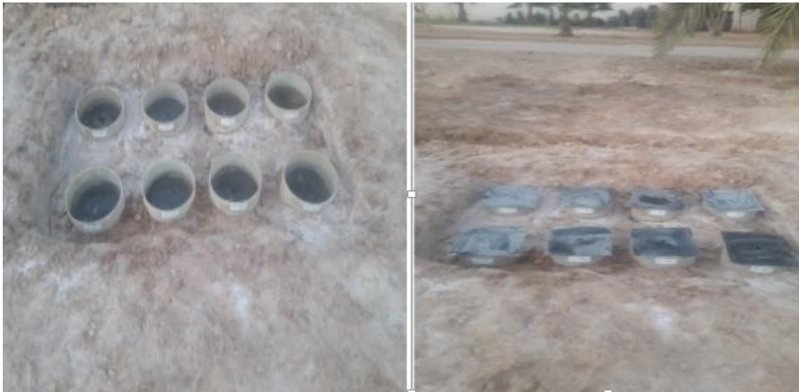
Figure IV.64 : Conservation des regards prototypes dans un milieu agressif dans la STEP de Touggourt.
