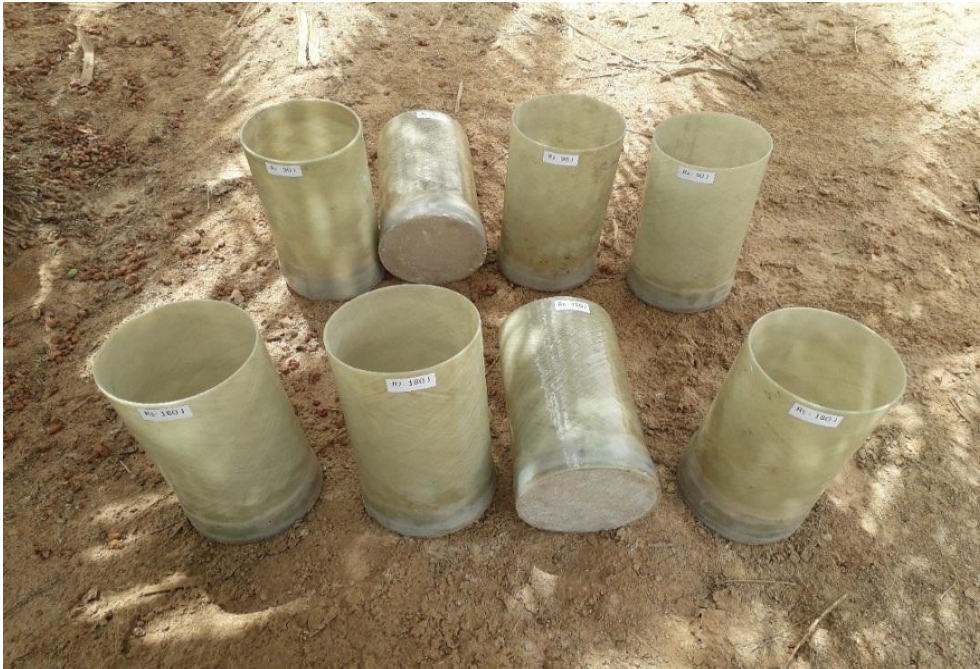
Figure IV .63 : Regards prototypes pour assainissement.
