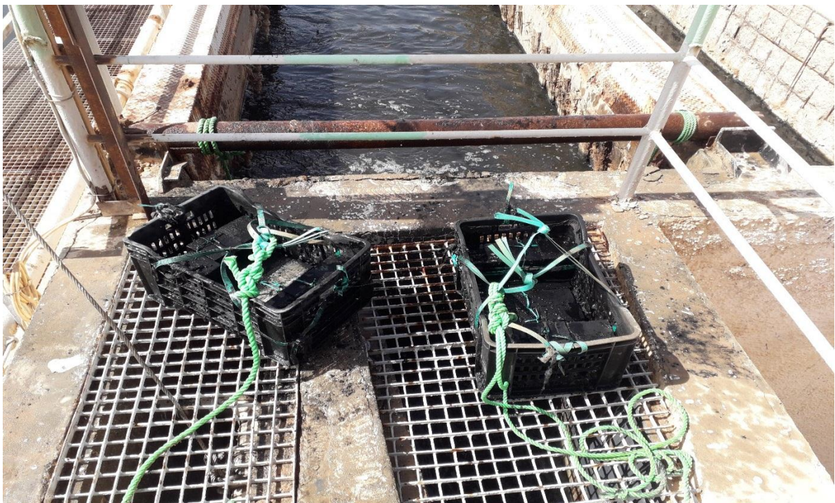
Figure IV.17 : Suivi de protocole séchage mouillage des éprouvettes.
