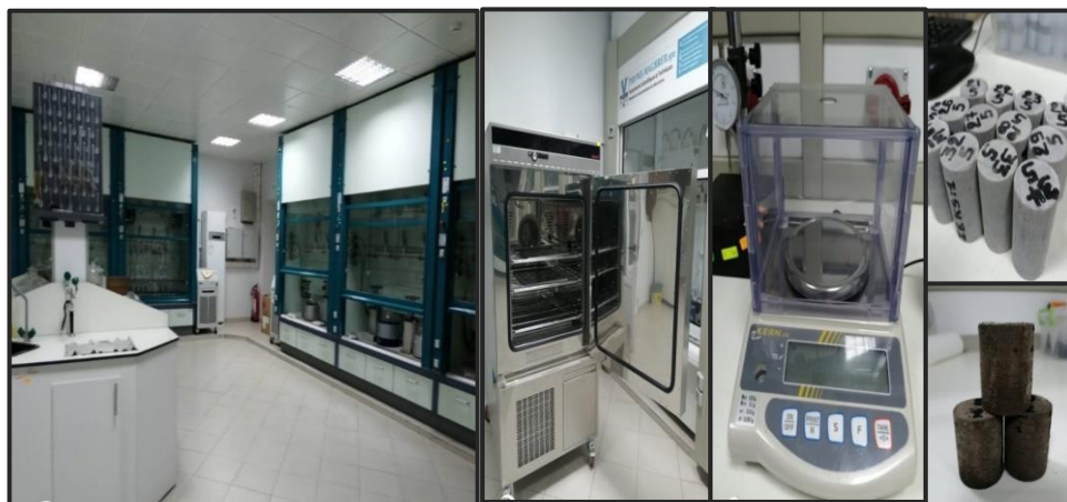
Figure.06 : Préparation et conditionnement des plugs de carottes (CRD 2018).
