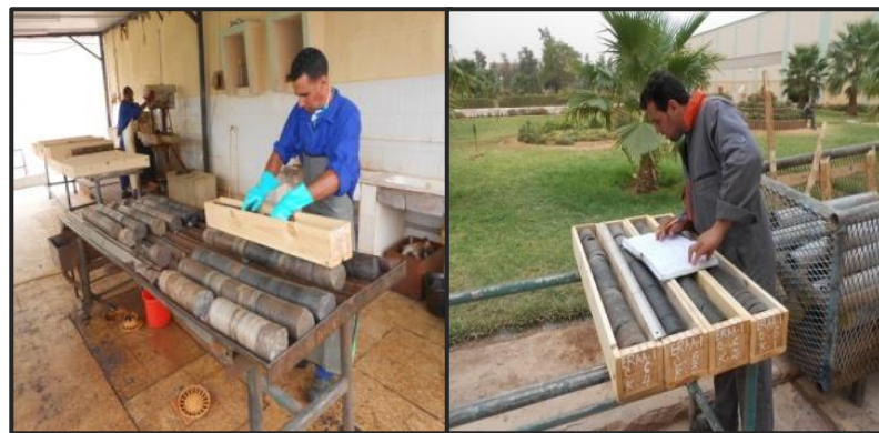
Figure.04 : Carotte laver et préparé pour analyse (CRD 2018).
