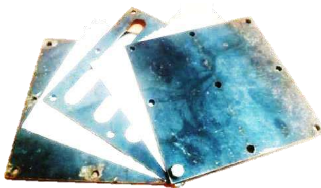
Figure 3.5 : Moule pour quatre éprouvettes de traction
