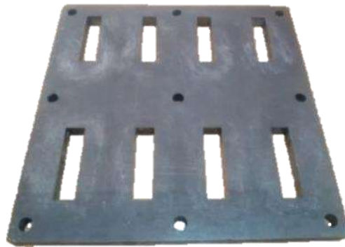
Figure 3.7 : Pièce médiane du moule pour les échantillons d'essai d'impact.
