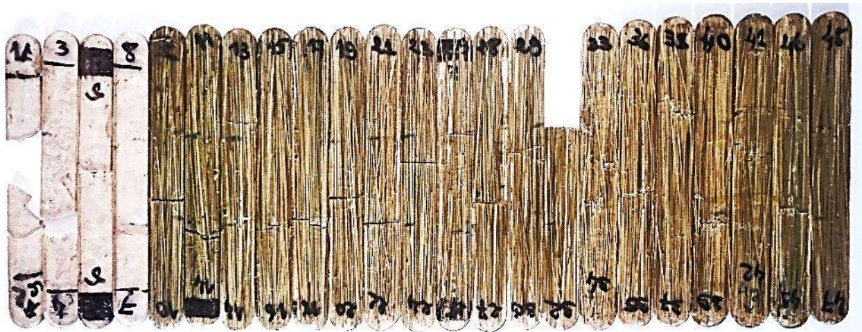
Figure 3.6 : Éprouvettes pour essai de traction avec différents pourcentages de poids en fibres Diss (après test)
