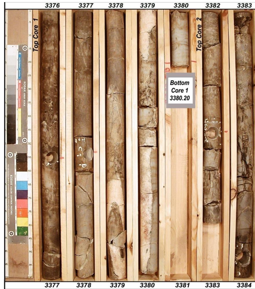
Figure 12: Carottes du réservoir des Quartzites de Hamra dans le puits HGAS-2, montrant des quartzites compacts et fissurés . Source : BEICIP–SONATRACH, 2007.
