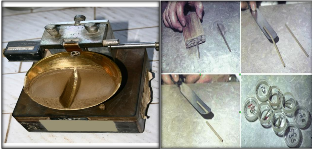
Fig II 06 : Matérielles de limite Atterberg (casagrande et spatule).
