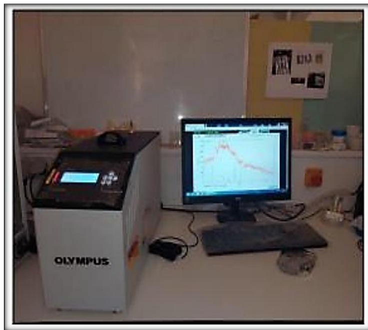
Fig II 09 : Appareil de diffraction des rayons X (DRX) utilisé pour l'analyse minéralogique.
