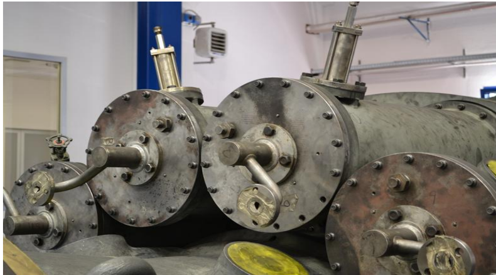
Figure II. 7. Bougies d'allumage rétractable [11]
