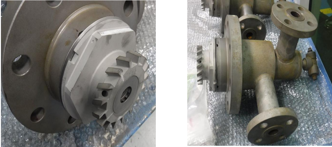
Figure II. 9. Injecteur de combustible [11]
