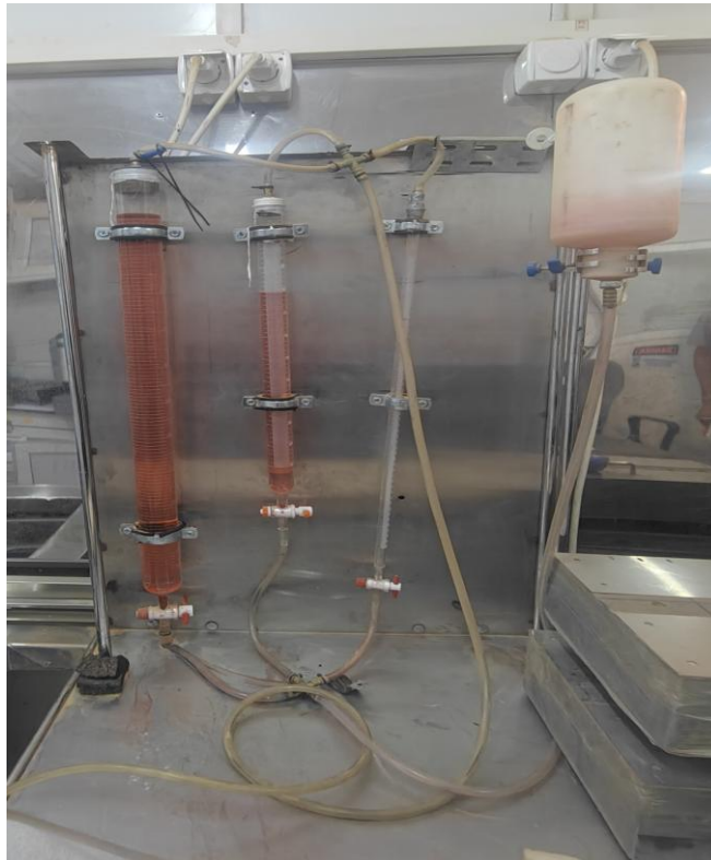
Figure III.6 : image indique la lecture rapide de la désorption de gaz sur site
