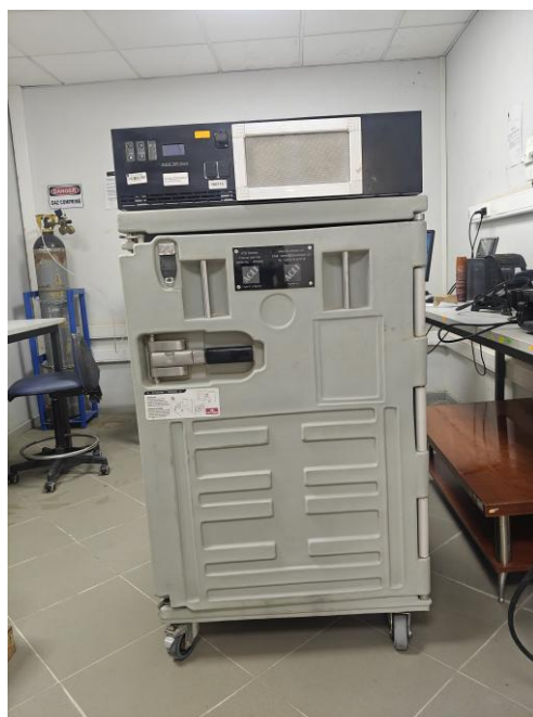
Figure III.9 : Unité réfrigérée mobile pour la conservation et le transport d'échantillons de désorption.
