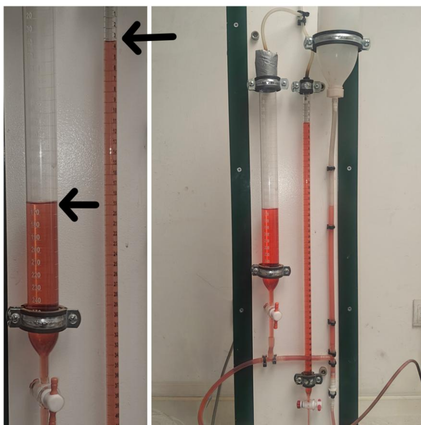
Figure III.7 : image indique la lecture du volume de gaz désorbé au manomètre en laboratoire
