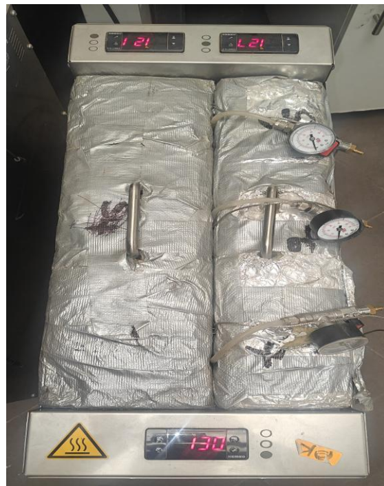
Figure III.4 : Bac à eau pour le réchauffage des canisters
