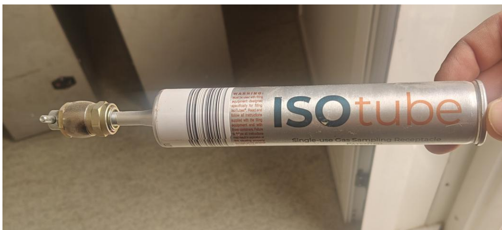
Figure III.8 : image indique l'iso tube d'échantillonnage de gaz (GC/ISO)
