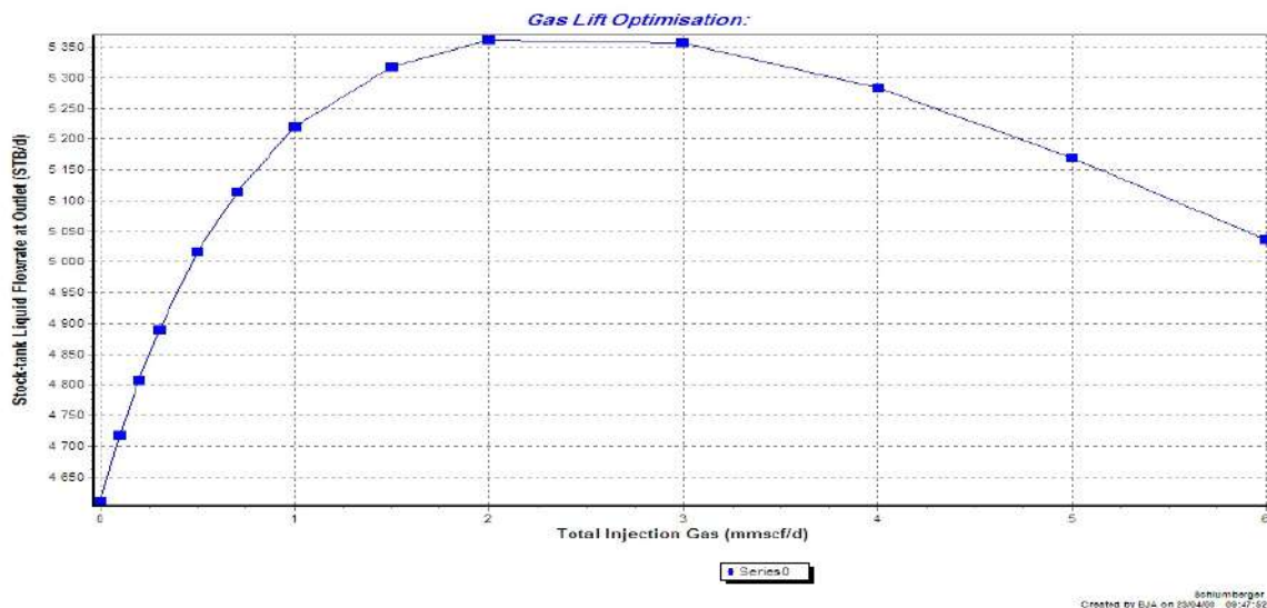
Figure II.1 : Débit de fluide du réservoir à la sortie en fonction de l'injection de gaz lift
