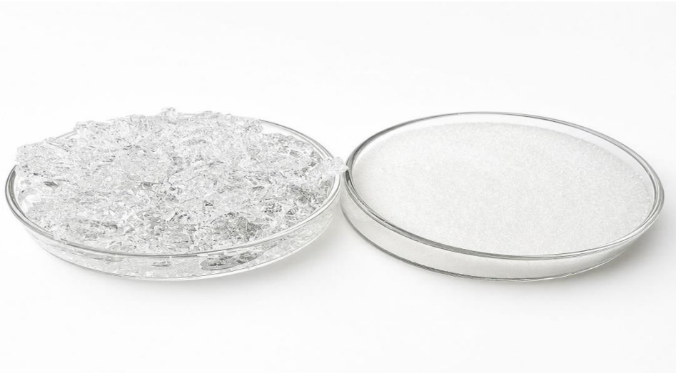
Figure2.4 : Morphologie granulaire d'un polymère super absorbant (SAP) à l'état sec
