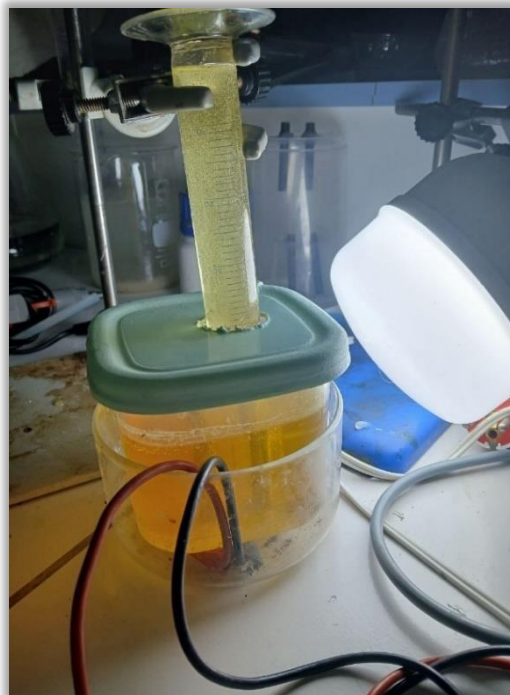
Figure IV.11 : Production de gaz par électrolyse l'eau issue des procédés pétroliers.
