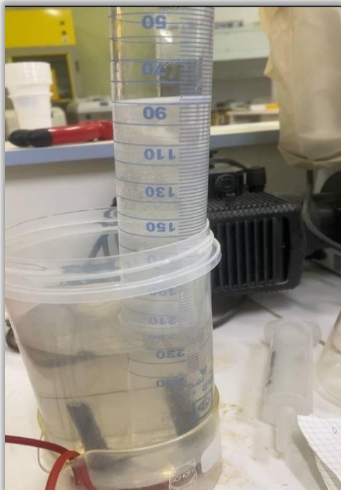
Figure IV.10 : Électrolyse de l'eau alcaline à l'aide d'électrodes en carbone (NaOH comme électrolyte).
