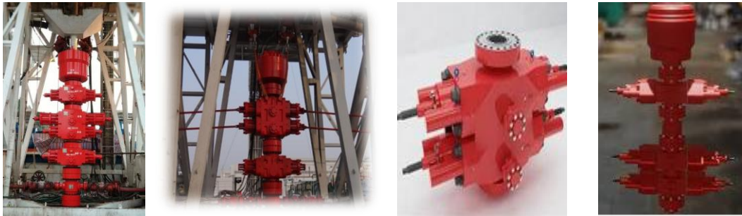
الشكل : II - 20 : أنظمة التحكم في البئر - بعض الأمثلة لمانع الانفجار.
