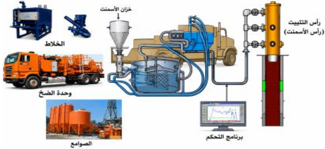
الشكل : III - 09: وحدة التسميت مع المخلاط، رأس التسميت، صومعة التخزين و وحدة الضخ.
