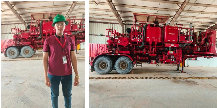
الشكل : III - 05 : وحدة ضخ و مزج الملاط الإسمنتي المتنقلة.
