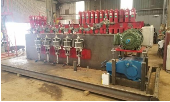
الشكل : II- 22:مجمع أو نظام التحكم.
