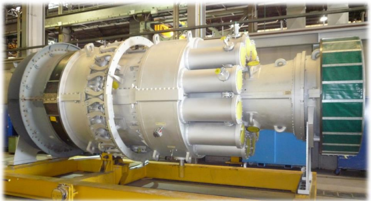
Figure II . 1 : turbine à gaz MS5002C [14]
