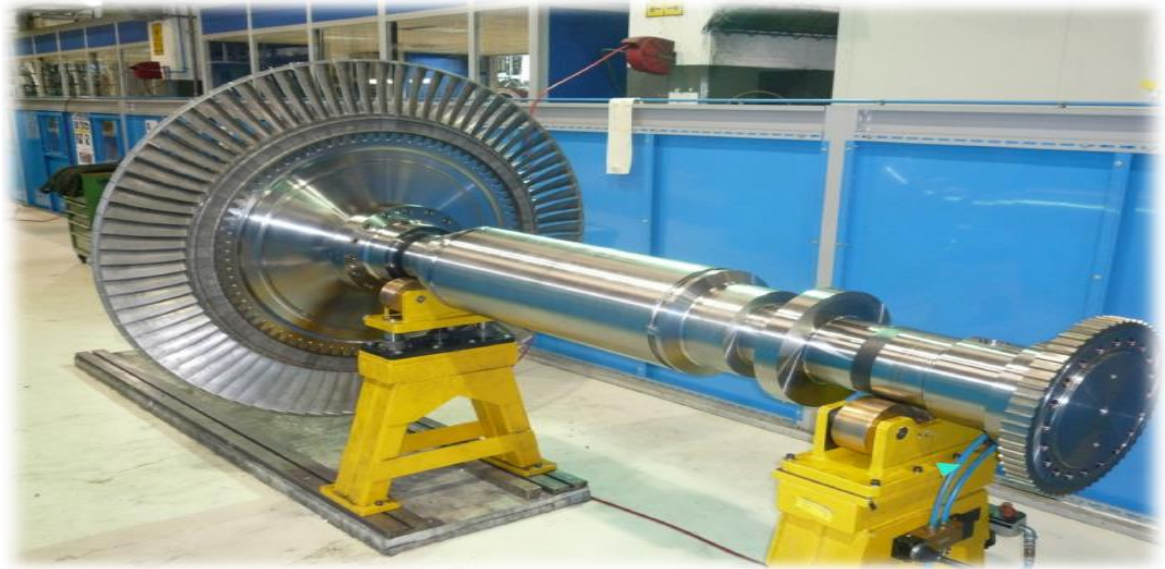
Figure II . 18 : Vue de l'ensemble rotor de turbine basse pression [14]
