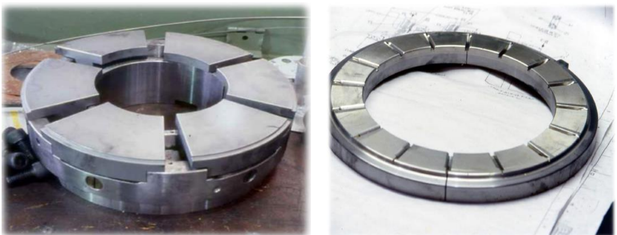
Figure II . 21 : Les Paliers butée active et inactive [14]
