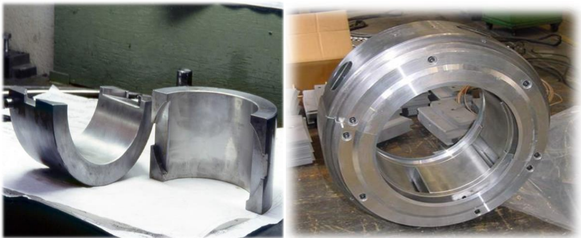
Figure II . 20 : Les Paliers porteur Elliptique et Patin oscillant [14]
