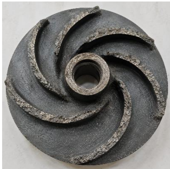
Figure III. 9 : Dégâts matériels causés par le phénomène de cavitation sur une turbine.
