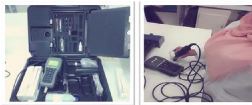
Figure II. 20 : Multi paramètre (pH, conductivité, TDS, salinité).
