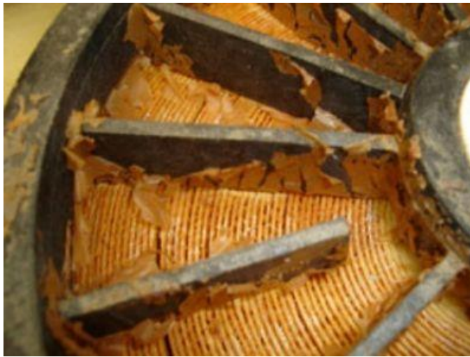
Figure I. 8 : Phénomène de colmatage sur membrane d'osmose inverse [6].
