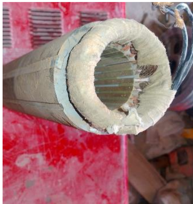
Figure III. 14 : Grillage des bobinages du moteur électrique.
