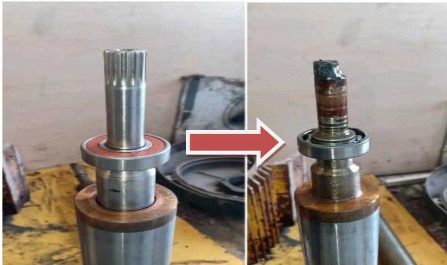
Figure III .8 : Érosion d'une partie de l'arbre de la pompe.
