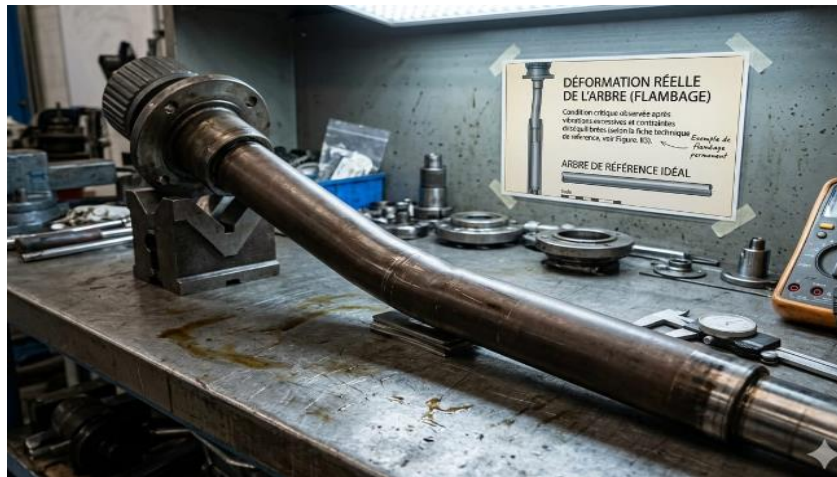
Figure III.13 : Flambage ou déformation résiduelle de l'arbre.
