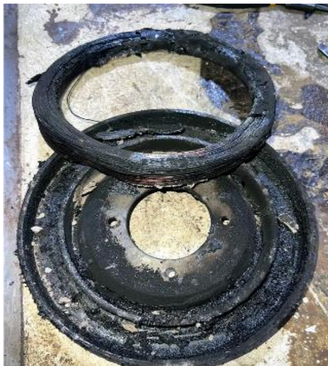
Figure III. 4 : Vue du joint d'étanchéité sur la flasque.
