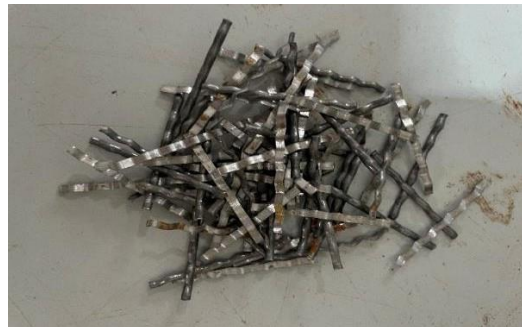
Figure II.14: La géométrie de fibres métalliques utilisées
