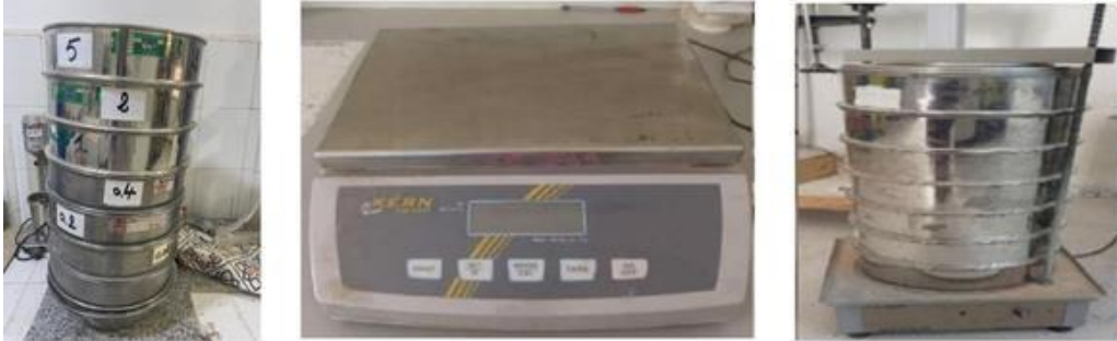
Figure II.1 : Les équipements utilisés pour la granulométrie
