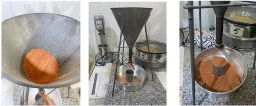
Figure II.9: Mode d'opération d'essai masse volumique apparent de poudre déchet de brique
