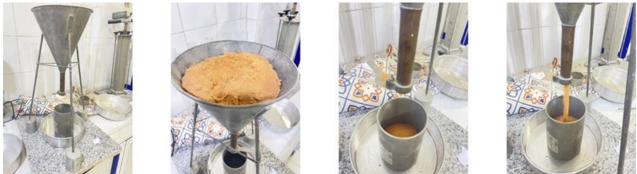
Figure II.3 : Essai De La Masse Volumique Apparente
