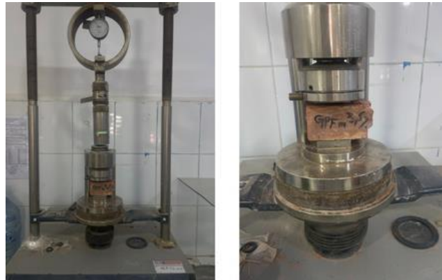
Figure III.9: L'essai de Résistance à La compression
