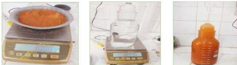
Figure II.8: Mode d'opération d'essai masse volumique absolue de poudre déchet de brique
