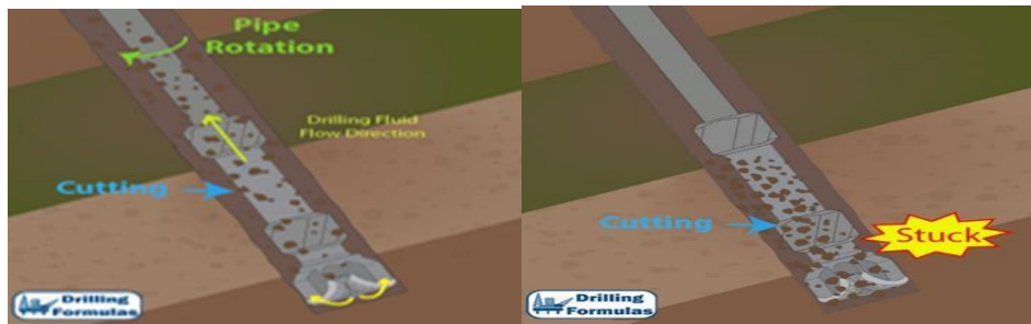
Figure II-1. Blocage de colonnes par accumulation de matière étrangère dans le trou (Harish's, 2015)
