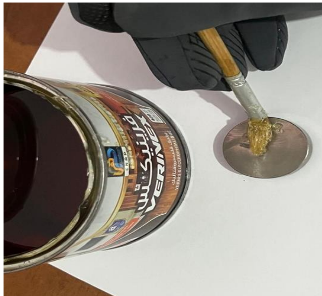
Figure.II.9 : Application d'une couche de vernis sur l'échantillon
