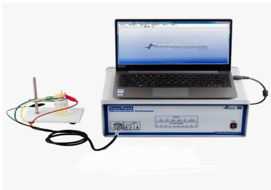
Figure I.13 : Potentiostat utilisé pour les essais électrochimiques. [24]
