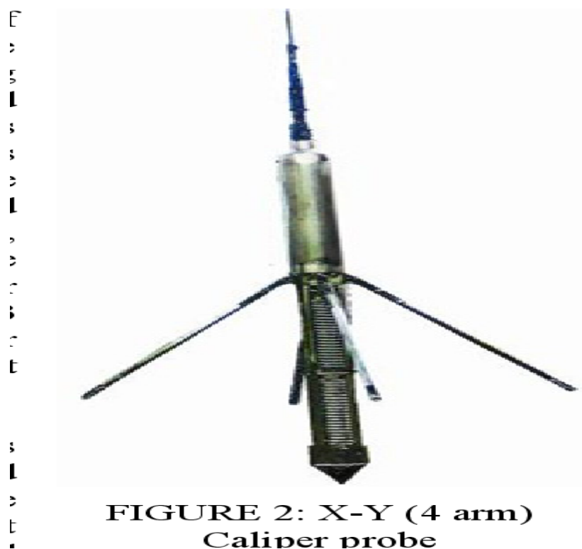
Figure 15 : le caliper (diamètreur), source:log hydro
