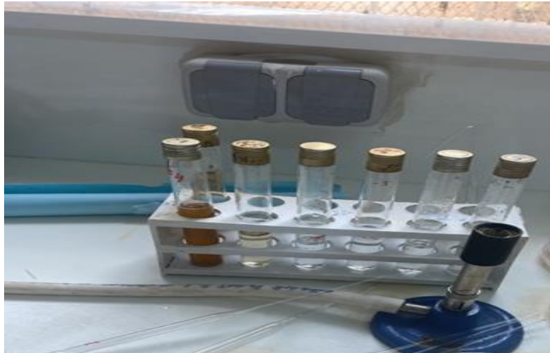
Figure : Étapes de préparation des dilutions décimales ( 10^{-1} à 10^{-5} ) de la boisson traditionnelle DEFFI pour les analyses microbiologiques (Saighi et Hachemi 2026)
