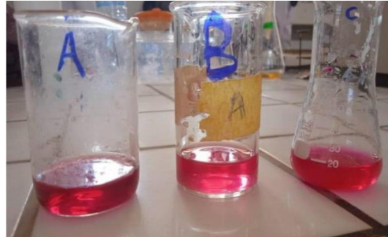
Coloration rose à l'équivalence lors du titrage titrage par NaOH
