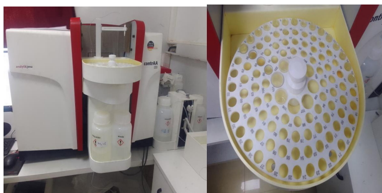
Figure 11.- Spectrophotomètre d'absorption atomique et support d'échantillons utilisés pour le dosage des éléments minéraux.
